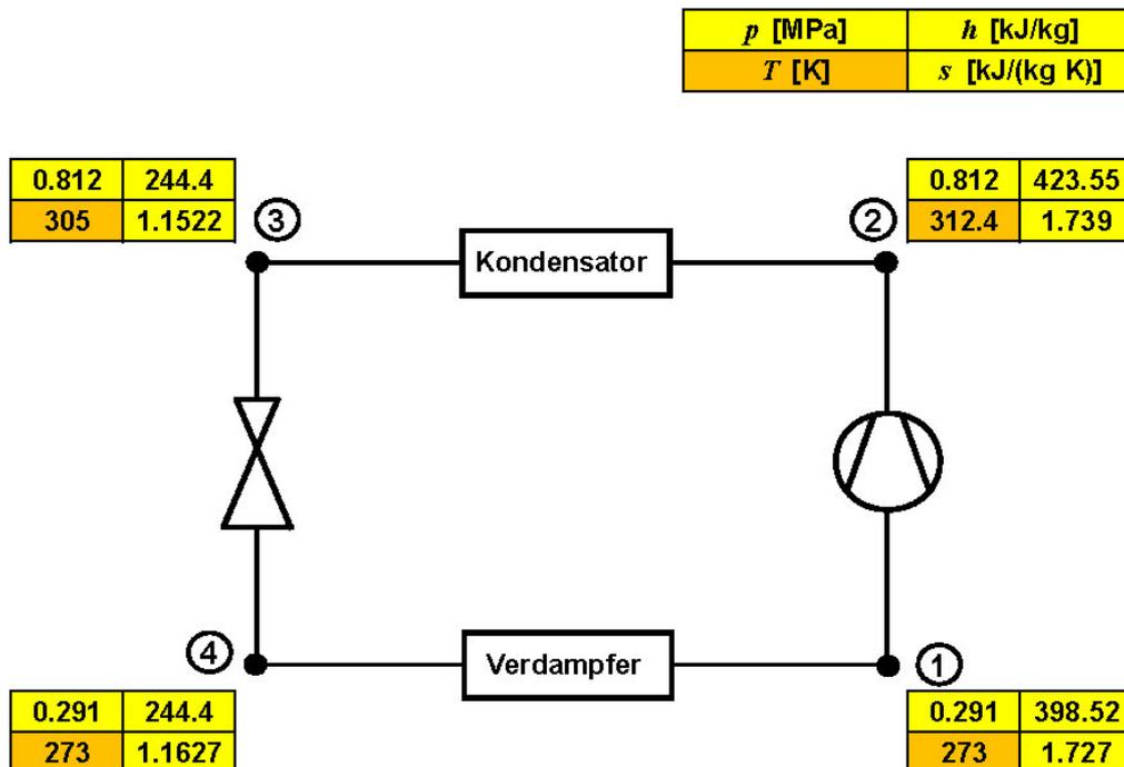
a) Berechnen Sie den spezifischen Exergieverlust der Wärmepumpe bei der Drosselung und bei der Wärmeaufnahme im Verdampfer. Die Temperatur des Grundwassers, dem die Wärme entnommen wird, beträgt im Mittel  $T_G = 278 \text{ K}$ . (6 P)
