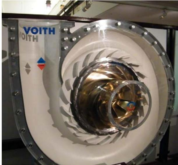
Abb. 1: Pumpenturbine von Voith
